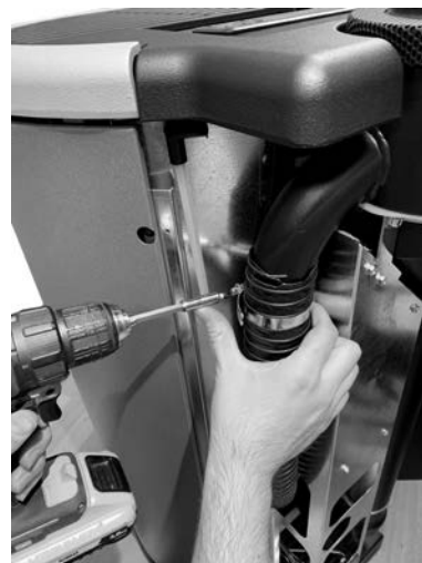
Fig. 54 - Sfilare tubo flessibile
