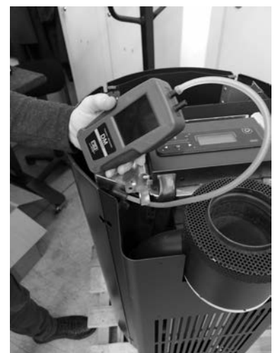
Fig. 62 - Collegamento pressostato digitale
